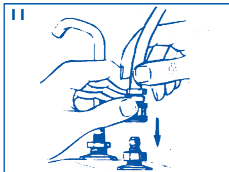
(11) Innestare il raccordo rapido sull'attacco di entrata del dispositivo tenendo premuto verso l'alto il collare scorrevole. Inserire fino in fondo il raccordo e rilasciare il collare assicurandosi che il raccordo si fissi con un leggero scatto.
