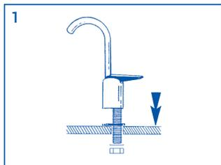
(1) Praticare un foro da 16 mm. nel piano del lavello e inserire il rubinetto fissandolo con dado e rondelle.
